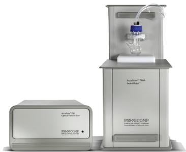
AccuSizer 780系列仪器采用单颗粒光学传感技术(SPOS)对大量粒子样本进行粒径测试并计数，一次检测一个粒子，来构建真正的粒径分布(PSD)。运用SPOS技术与激光衍射和沉降法所得到的粒径统计学分布数据形成了鲜明对比，SPOS技术能够在测量粒径的同时收集颗粒数目信息，对颗粒进行精确的计数。
